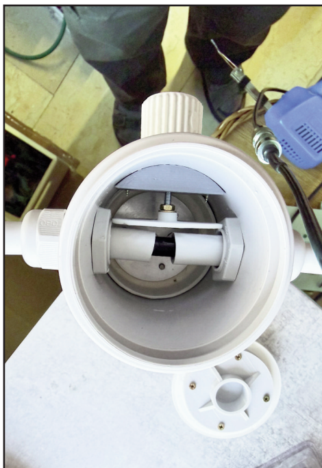
Obr. 11 a 12: MLA-ER pro pásmo 14 MHz –detail konstrukčního uspořádání
