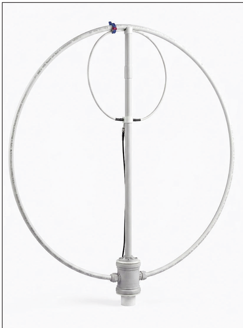
Obr. 6: MLA-ER pro pásmo 14 MHz s využitím instalatérských plastových dílů a kabelových vývodů PG
