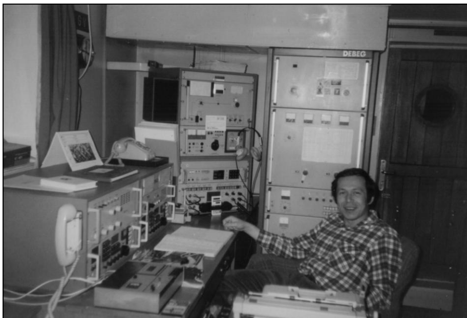
Já v radiokabině lodi Lipno OLGV, rok 1991, za mnou hlavní vysílač DEBEG, na PA 4x 4CX250, nejvyšší šuplík je anténní přepínač. Stojan vlevo zdola přepínací panel, automatický SOS dávač, nabíječ staniční baterie, záložní 500 kHz vysílač – vlevo přepínač diskretních kmitočtů, vpravo otáčení variátorem. Na stole dole dva komunikační přijímače DEBEG, vlevo nahoře VHF radiostanice, vpravo autoalarm přijímač 500 kHz
